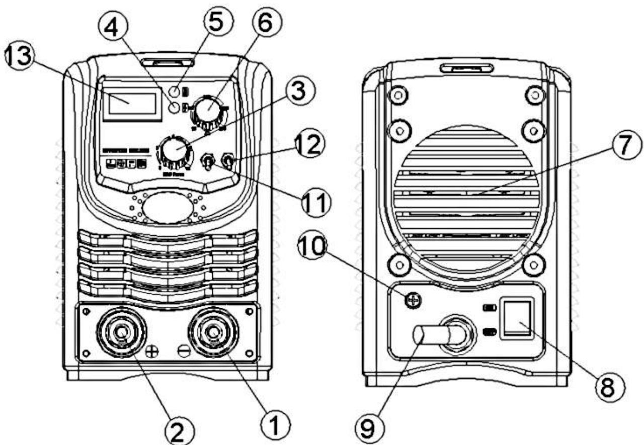
1. Клемма «-», для подключения зажима массы.
